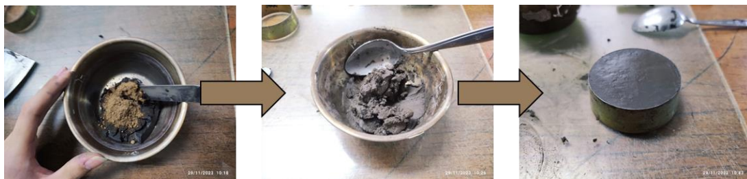
Gambar 3. Proses pencampuran sampel soil gedebage dan fly ash kering
