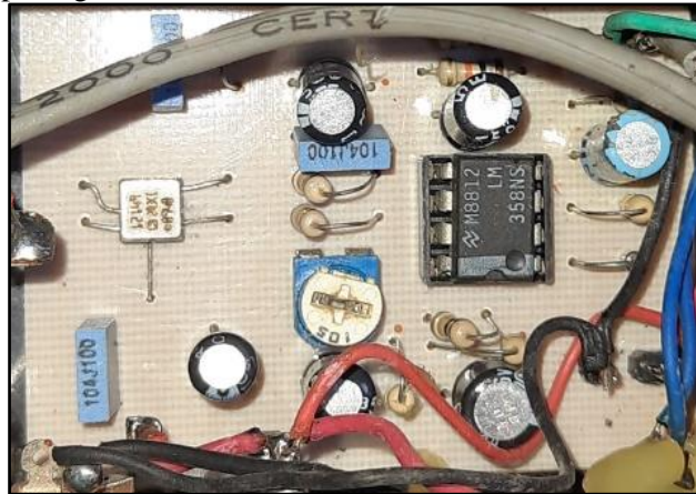
Gambar 6. Perangkat keras sensor ADXL203 dan rangkaian pengondisi sinyal
